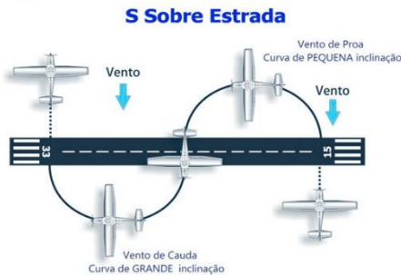
Figura 1-11. Execução do S sobre estrada.
